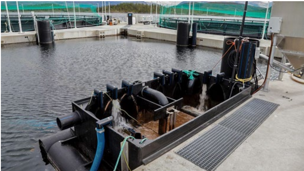
Figur 11.6. Akvafuture - slamoppsamling fra matfiskoppdrett. Foto: Akvafuture
